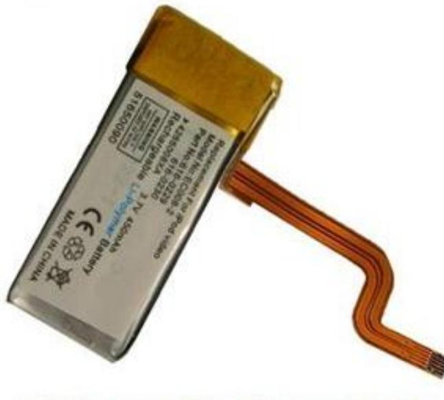
*Figura 3.4. Batería de Litio–ión polímero utilizada en este proyecto.*
