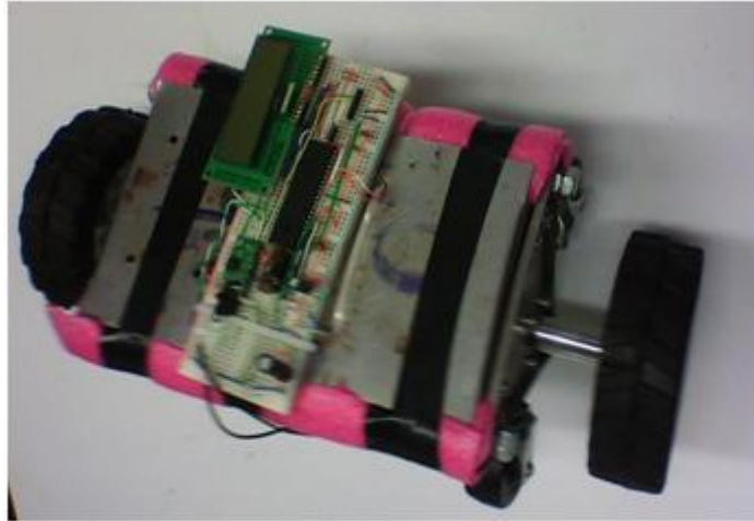
Imagen 17. Prototipo con circuito de control de prueba.
