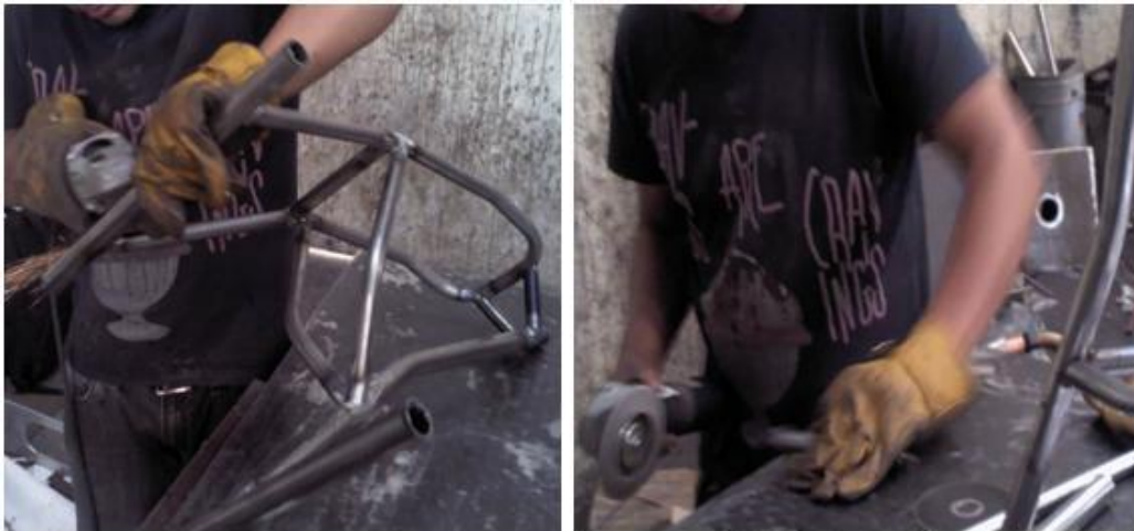
Imagen 72. Imágenes de manufactura de estructura principal.
