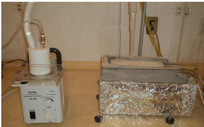
**Figura 21.** Imagen de sistema de rocío pirolítico instalado en el laboratorio de Preparación de Muestras.
