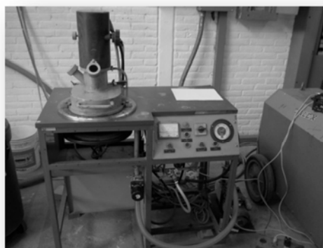
Fig. 3.2. Horno de arco eléctrico.
