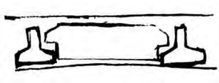
Fig. 97 Losa; vigueta y bovedilla de poliestireno
