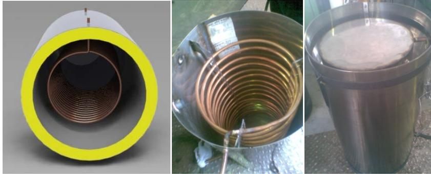
Figura 33: Diseño y construcción del termotanque.
