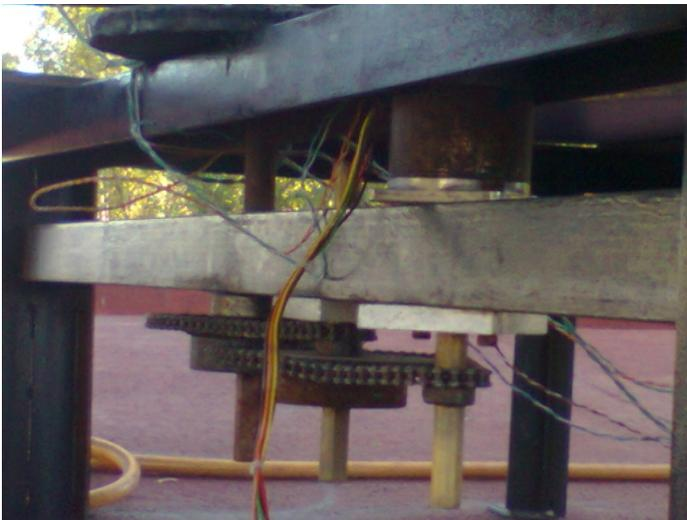
Figura 47: Sistema fabricado para la transmisión de movimiento.
