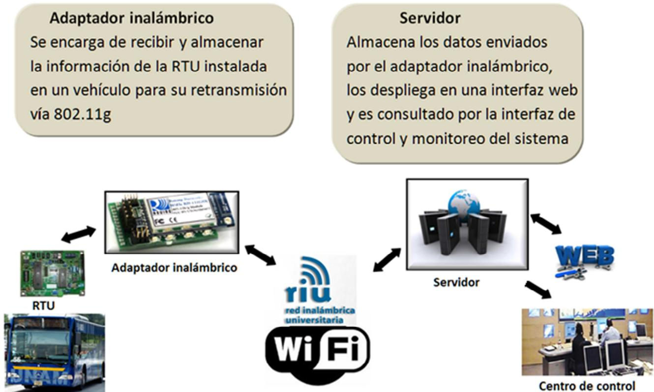
Figura 3.1 Esquema general del canal de comunicación Wi-Fi.
