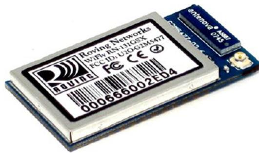
Figura 2.2 Vista real del módulo WiFly RN-131GSX.
