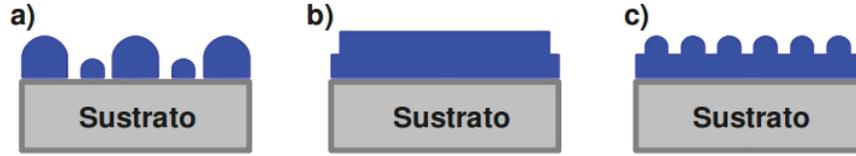
Figura 1.8: Procesos de crecimiento. a) Volmer-Weber, crecimiento en islas. b) Frank-Van der Merwe, película delgada uniforme. c) Stranski-Krastanov, combinación de los anteriores.
