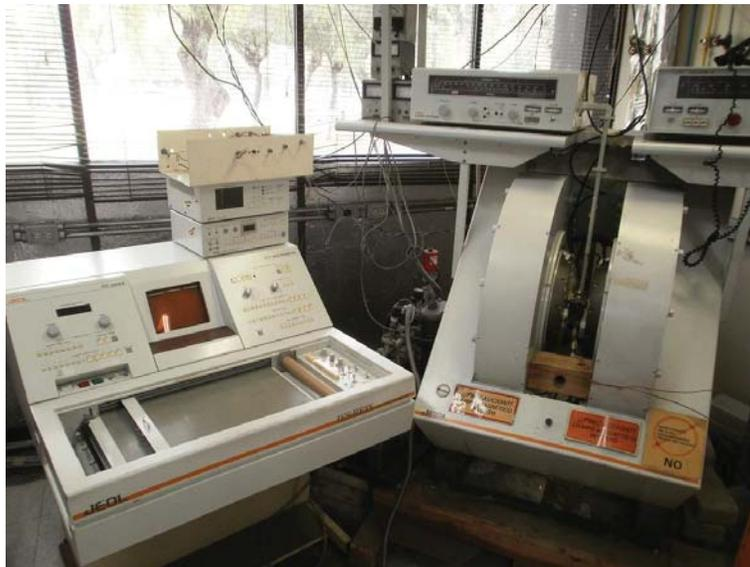
Figura 3.27: Espectrómetro de resonancia paramagnética electrónica.
