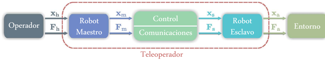
Figura 1.2 – Modelo de un sistema de teleoperación unilateral
