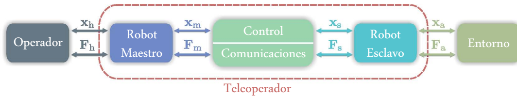
Figura 1.3 – Modelo de un sistema de teleoperación bilateral
