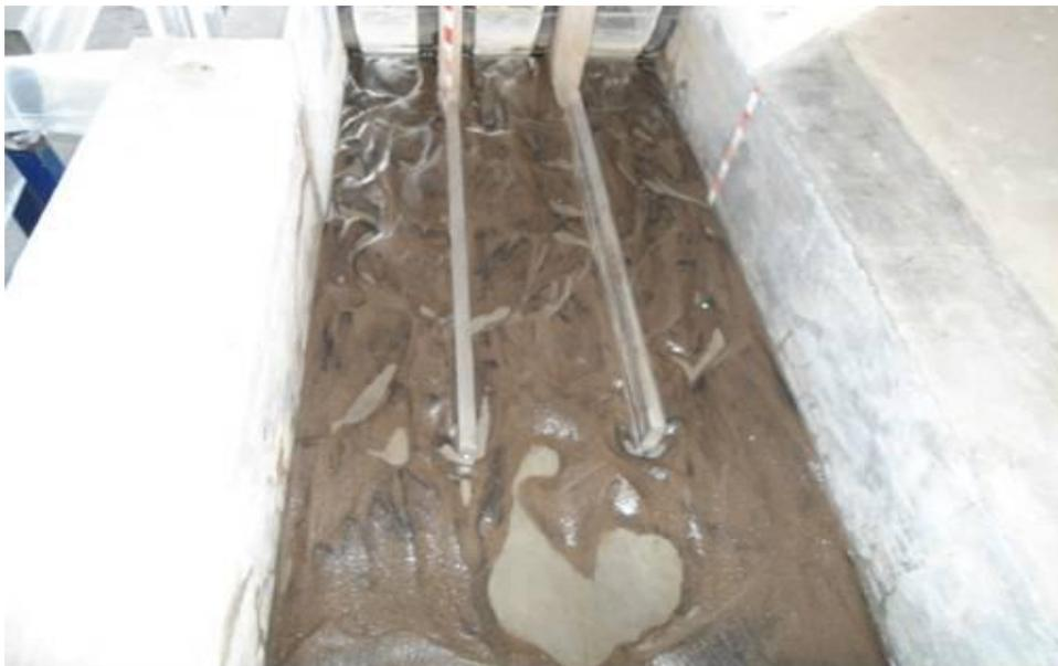
Figura 4.12 Funcionamiento del desarenador, arrastre de sedimento después de 2.23 hrs de prototipo, gasto 458 m<sup>3</sup>/s.
