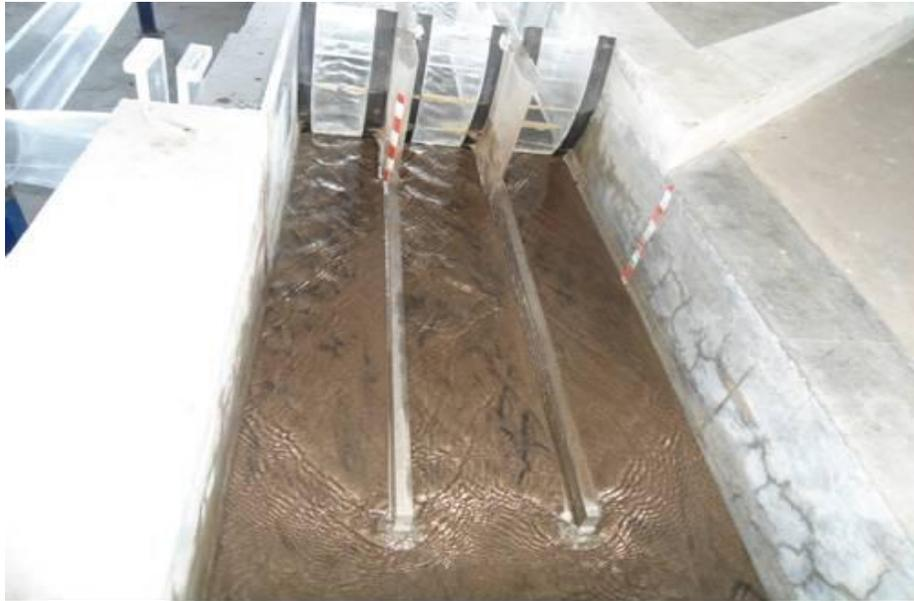
Figura 4.11 Funcionamiento del desarenador proyectado con arena Pumitica, gasto 458 m<sup>3</sup>/s.
