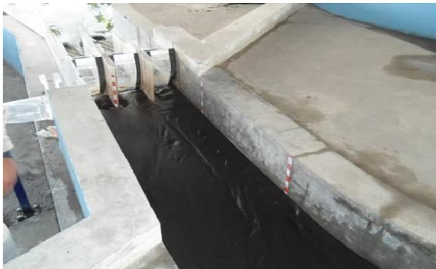
Figura 4.10 Funcionamiento del desarenador, arrastre de sedimento después de 2,23 hrs de prototipo, gasto 458 m<sup>3</sup>/s.
