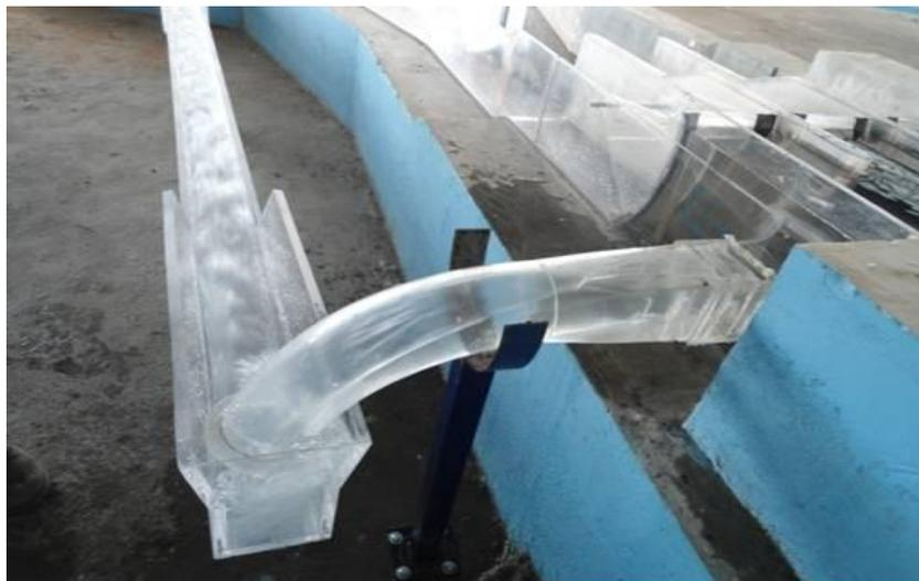
Figura 4.14 Funcionamiento de la obra de toma.
