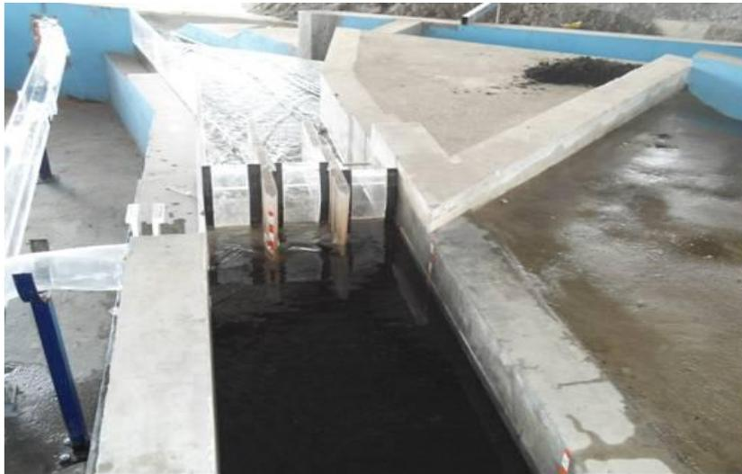
Figura 4.8 Funcionamiento del desarenador proyectado con arena volcánica, gasto 300 m<sup>3</sup>/s.
