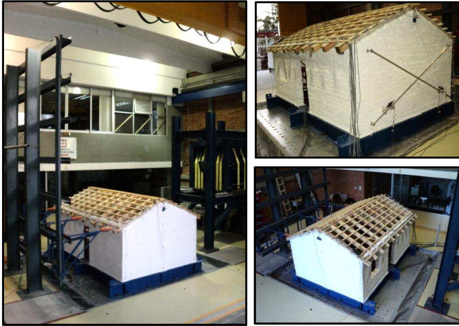
Figura 3.36 Modelo uno instrumentado sobre la mesa vibradora
