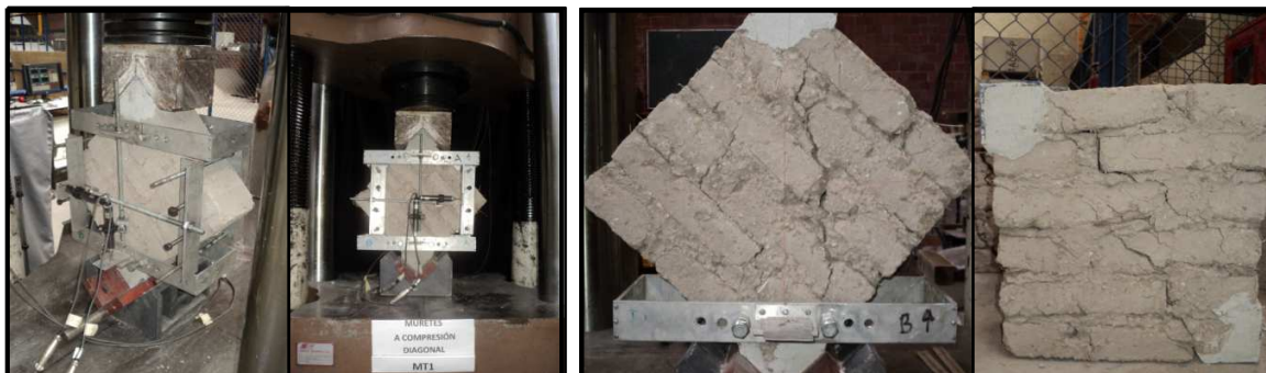
Figura 3.16 Ensayo de muretes (Izquierda) y algunos tipos de fallas (Derecha)
