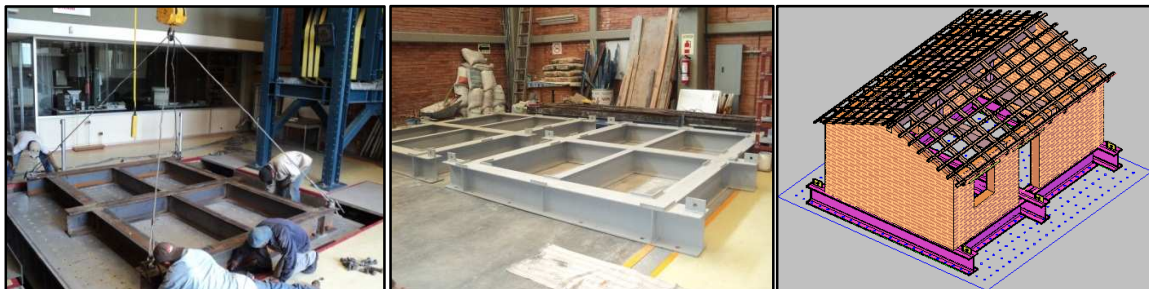
Figura 3.21 Base de acero para el traslado y fijación del modelo en la mesa vibradora
