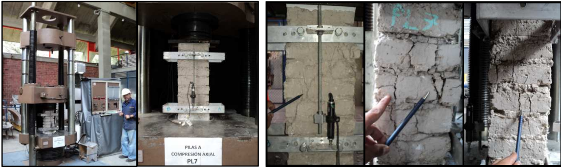
Figura 3.14 Ensayo de pilas (Izquierda) y algunos tipos de fallas (Derecha)
