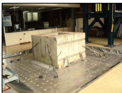
Figura 3.34 Masa equivalente sobre la mesa vibradora
