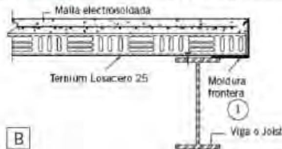
Láminas perpendiculares a las vigas
