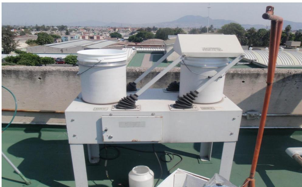
**Figura 9 - Colector automático húmedo/seco.**
