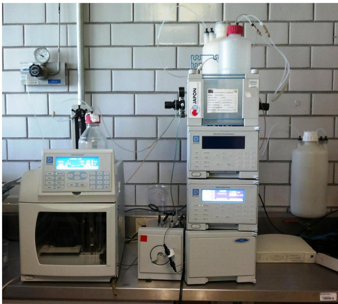
**Figura 16 - Equipo para cromatografía por intercambio iónico para identificación de aniones DIONEX - DX500 Fuente: Lab. de cromatografía de líquidos de la DGCENICA.**
