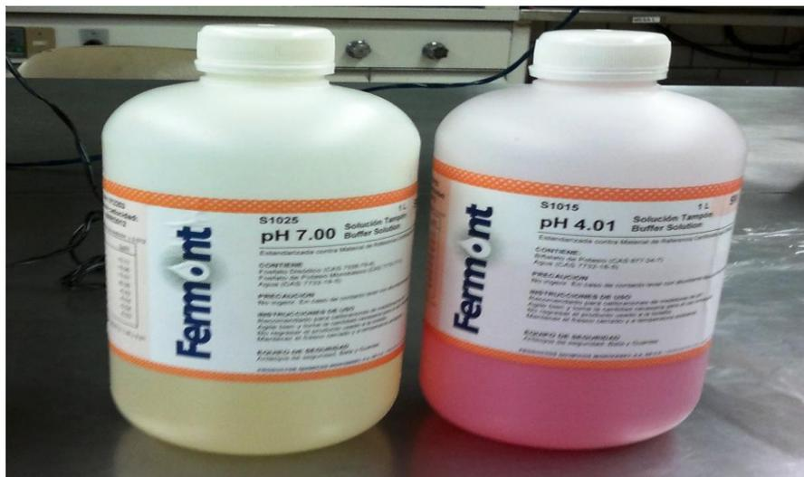
**Figura 39 - Buffer para Calibración de pH. Marca Fermont. pH = 7.00 y pH = 4.01**
