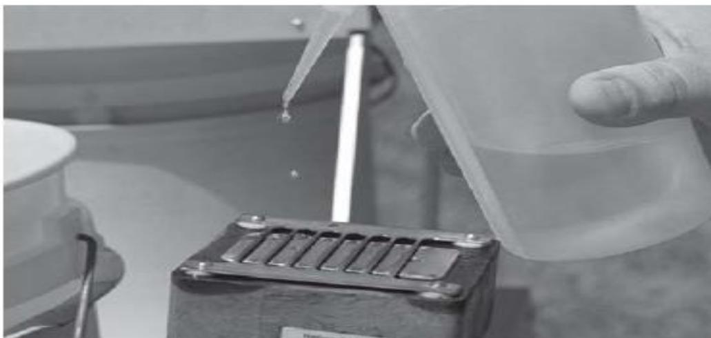
**Figura 11 - Activación del sensor de humedad del colector por medio de una piseta con agua. Fuente: Estudio piloto para la operación de la Red Mexicana de Depositación Atmosférica, 2009.**
