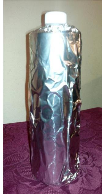
**Figura 10 - Botella de polipropileno para muestra de deposición húmeda cubierta con papel aluminio.**
