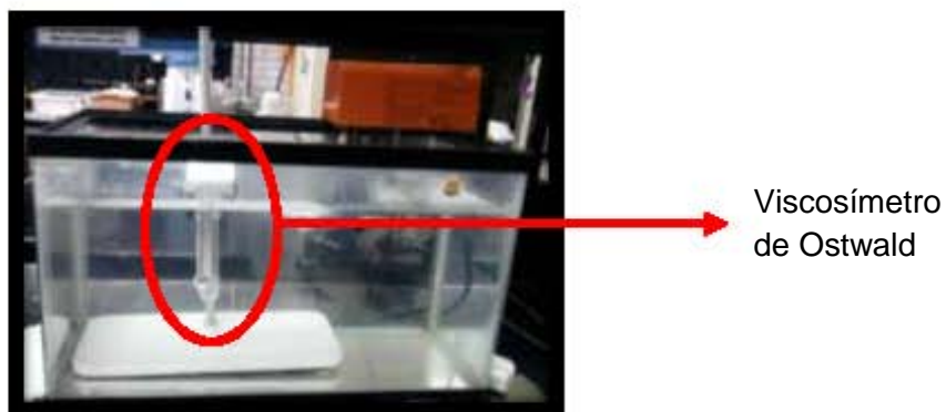
Figura 21. Viscosímetro Ostwald y equipo para determinación de peso molecular
