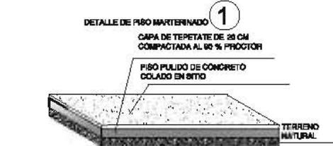
TERMINADO DE PISO SE COLOCARA SOBRE EL TERRENO NATURAL UNA CAPA DE TEPETATE DE 20 CM COMPRIMIDO AL 90 % PROCTOR SOBRE EL CUAL SE VACIARA EL CONCRETO PARA EL PISO DE 10 CM DE ESPESOR DESPUES SE PROCEDERA A PULIRLO CON CEMENTO GRIS. SE DEJARA SECAR POR UN TIEMPO DE 1 DIA DESPUES SE MARTHENARA MANUALMENTE CON MARTHENADORA.
