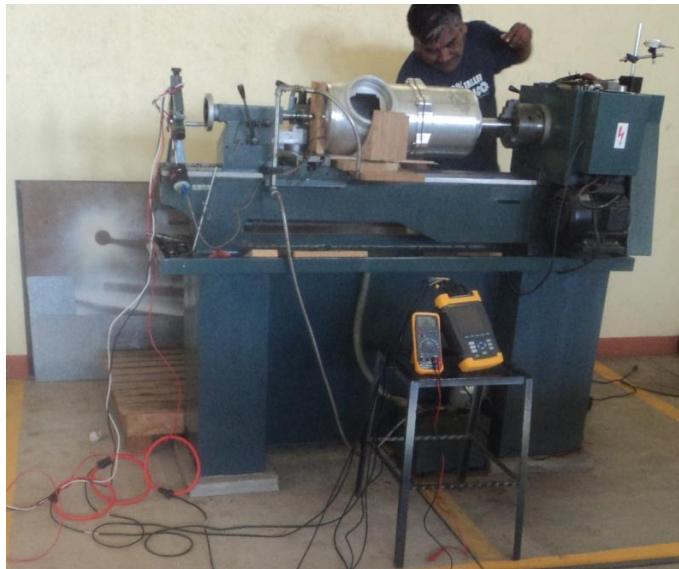
Figura 4-1. Prueba de circuito abierto del generador eléctrico.
