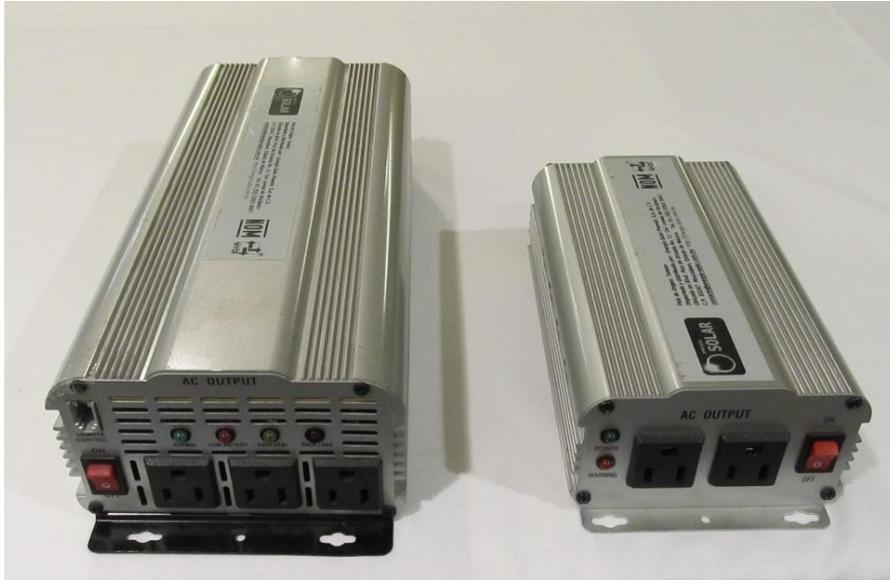
**Ilustración 55.-Inversores de corriente**
