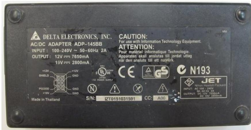
**Ilustración 56.- Vista de la fuente de poder del prototipo**
