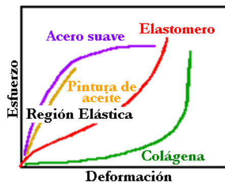
Figura 14. Diagrama esfuerzo-deformación de algunos materiales en donde se observa a la colágena y la poca resistencia que presenta a ser deformada a niveles de esfuerzos pequeños.
