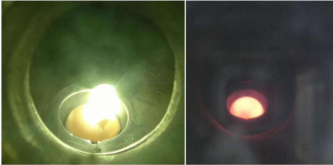
Figura 4.3 Fusión de los metales mediante arco eléctrico (izquierda) para formar una aleación homogénea (derecha).
