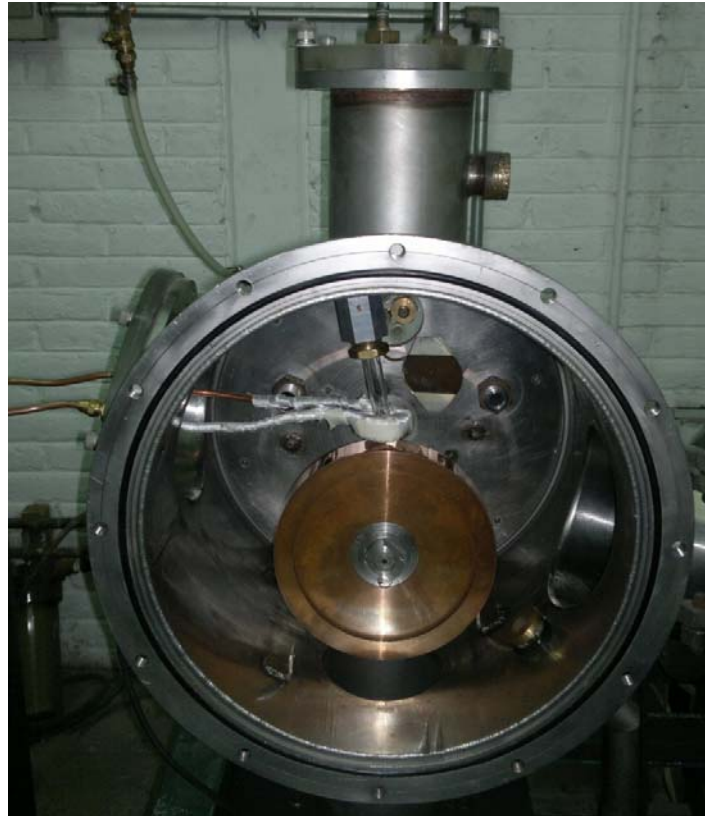
Figura 4.4 Equipo para obtener cintas vítreas mediante la técnica de melt spinning
