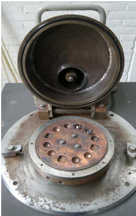
Figura 4.2 En los crisoles se colocó titanio puro y después los elementos que componen la aleación
