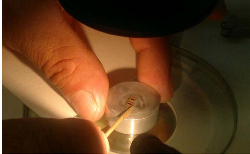
Figura 4.7 Montaje de la muestra para realizar el desgaste iónico para microscopía electrónica de transmisión
