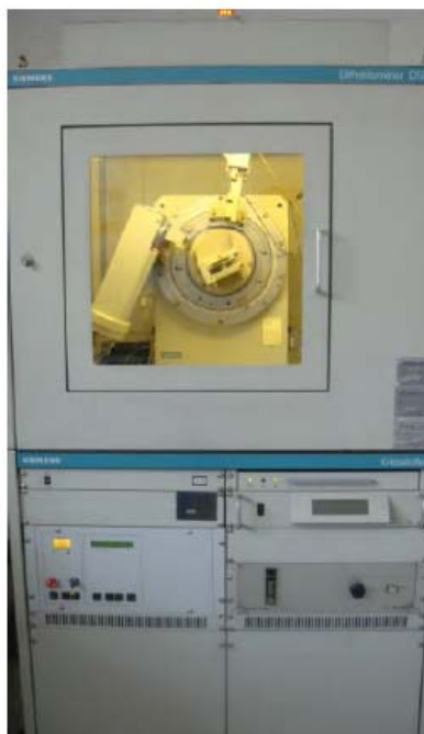
Figura 4.6 Difractómetro Siemens D5000 del Instituto de Investigaciones en Materiales.
