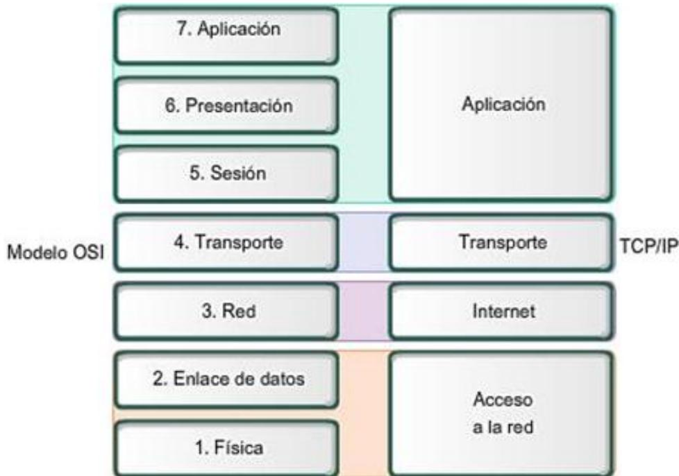
Figura 1.5 Comparación del modelo OSI y TCP/IP [2]
