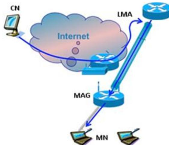
Figura 6.13: Comunicación de CN a MN en PMIPv6
