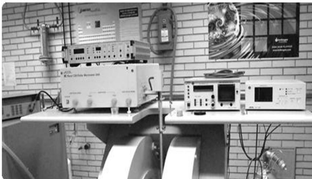
Fig. 5. Espectrómetro de Resonancia Paramagnética Electrónica Jeol, JES-TE300, Instituto de Química, UNAM<sup>3</sup>.
