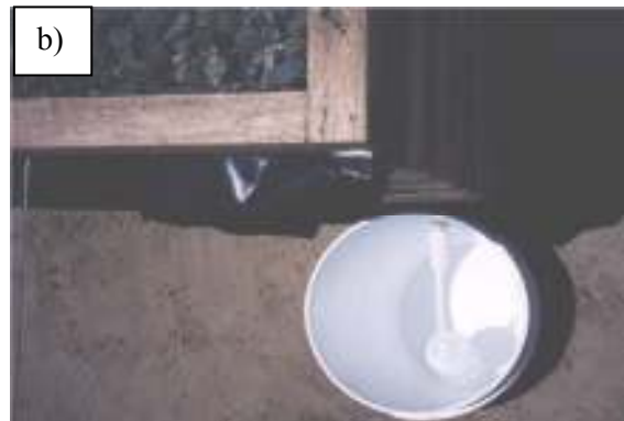
Figura 16: a) Pilas de lixiviación en campo; b) Sistema de recolección de solución de lixiviación; c) Testigos de perforación sin triturar en la pila de lixiviación en campo.
