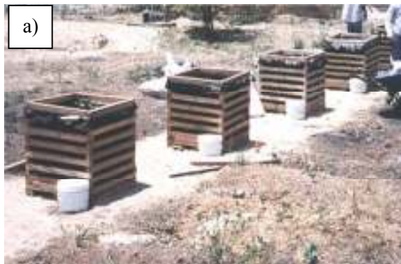
Figura 16: a) Pilas de lixiviación en campo; b) Sistema de recolección de solución de lixiviación; c) Testigos de perforación sin triturar en la pila de lixiviación en campo.
