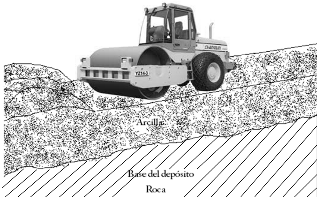
Figura 21: Impermeabilización de la base de la presa de jales con arcilla compactada.
