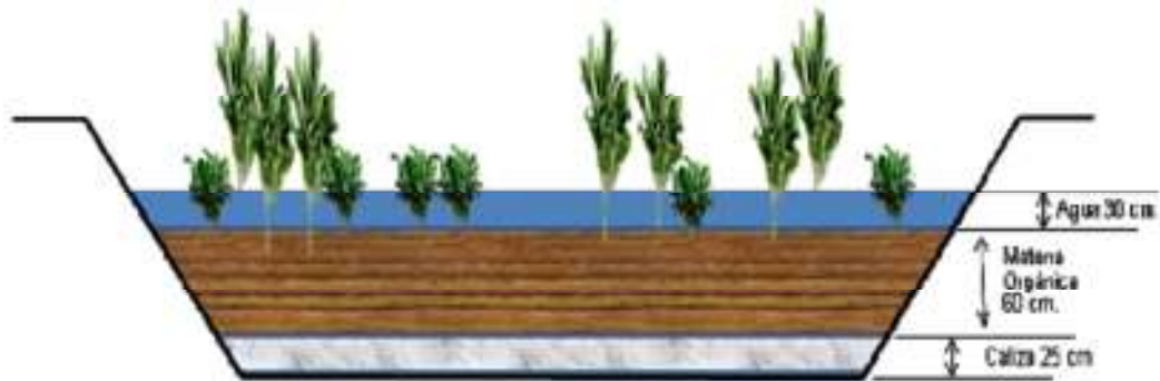
Figura 24: Esquema de humedal anaerobio. Obtenido de Sánchez-Rial y Ferreira-Centeno, 2011.
