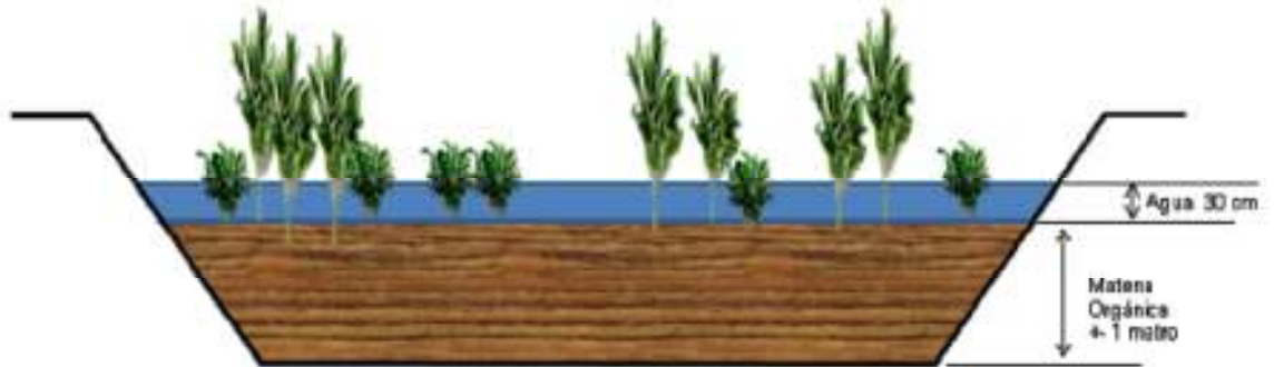
Figura 30: esquema de un humedal aeróbico. Obtenido de Sánchez-Rial y Ferreira-Centeno, 2011.
