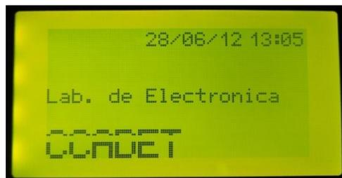
Figura 4.8 Ventana portada, se tiene la visualización del reloj y fecha configurados Permitiendo bloquear el acceso a las demás ventanas anteriormente descritas.
