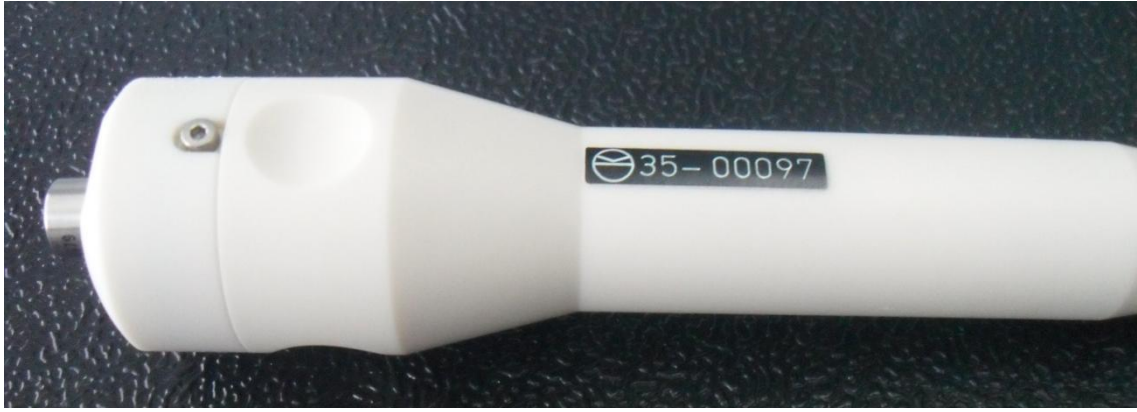
Imagen 5. Sonda de inmersión de 30MHz. El transductor puede cambiarse por 50 MHz.
