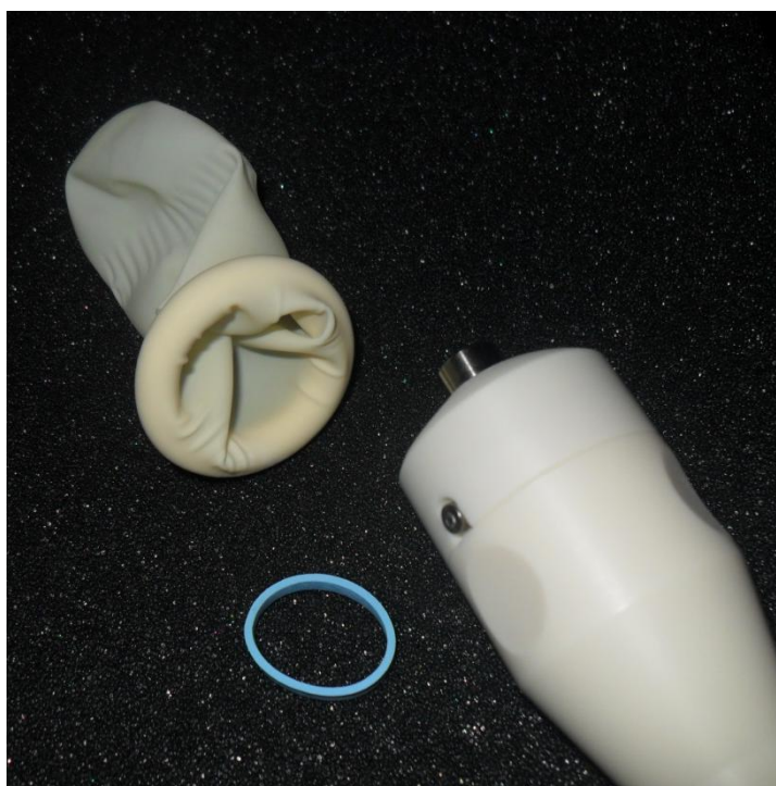
Imagen 4. Rolled Probe Cover. Capuchón especial de látex que se utilizó para cubrir la sonda y lograr un medio de inmersión.
