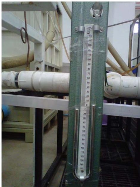
**Figura 3-5. Manómetro de mercurio.**
