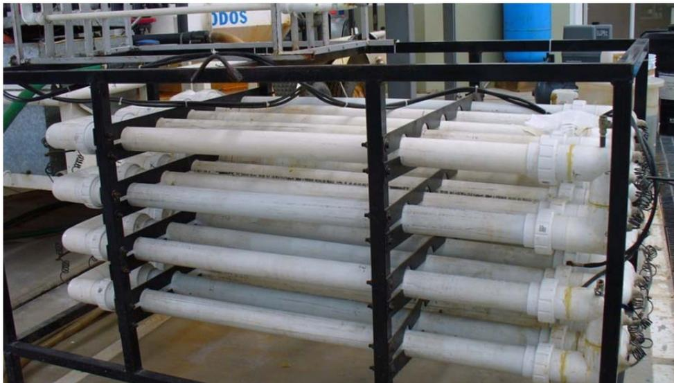
**Imagen 3-2 Reactor tubular horizontal R1.**
