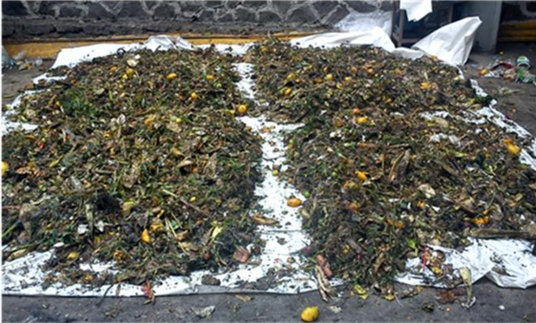
Figura 7.3. Formación de las cuatro zonas de residuos de acuerdo con el método del cuarteo
