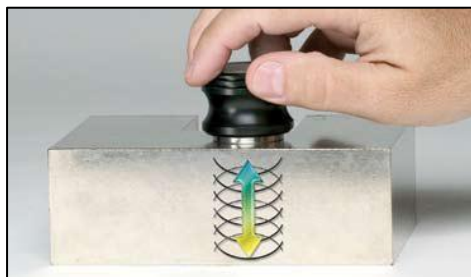
Figura 1.8 Recorrido de una onda longitudinal
