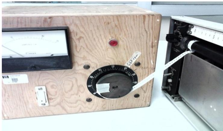
Figura 3.29 Acoplamiento de la graficadora y el variac.
