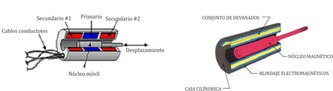
Figura 2.5 Estructura del LVDT.
