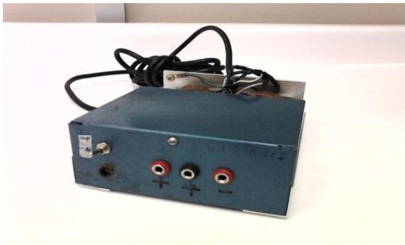
Figura 3.32 Fuente de alimentación CD.  $\pm 15v$ .
