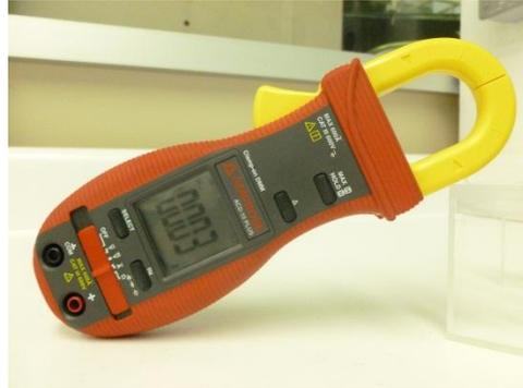
Figura 3.30 Amperímetro de gancho.
