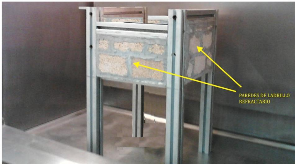
Figura 3.10 Paredes del horno.
