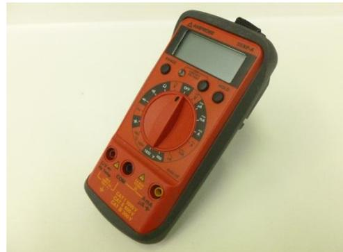
Figura 3.31 Multímetro digital.
