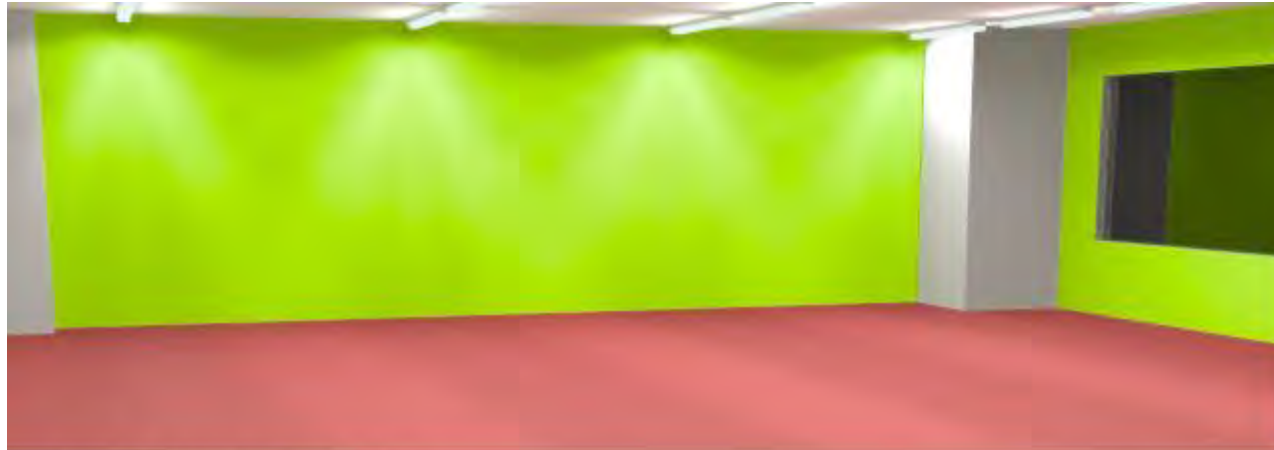
ÁREA DE TRABAJO INVESTIGACIÓN PROYECTO DE ILUMINACIÓN CON LUMINARIOS TL-5 DE 49W DE PHILIPS
