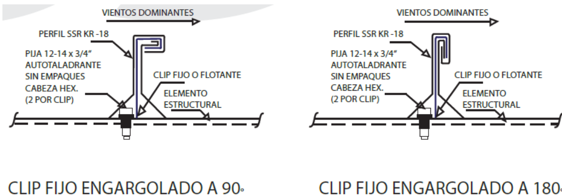
Figura 3.17. Forma de engargolamiento.
