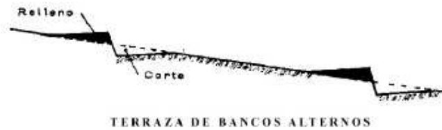
Fig 19. Sección transversal de terraza de bancos alternos
