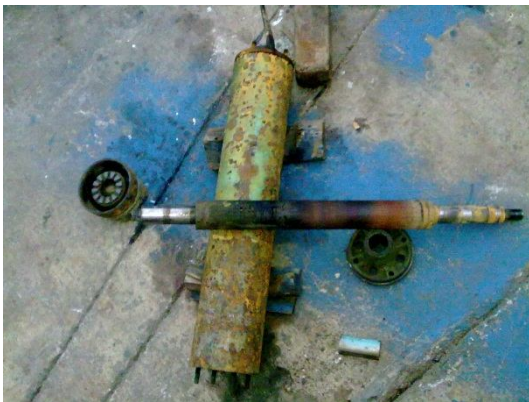
Figura No. 34 “Desarmado de motor sumergible dañado por sobrecarga”
