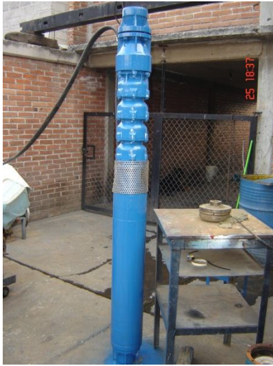
Figura No. 36 “Mantenimiento de bomba sumergible”
