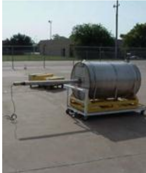
Figura 3.10. Calibración de la herramienta de Neutrones mediante patrón secundario.
