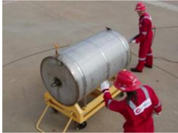
Figura 3.9. Tanque de calibración de las herramientas de Neutrón (patrón secundario).
