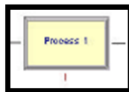
FIGURA 2-18 ILUSTRACIÓN DEL MÓDULO PROCESS
