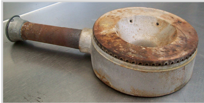
Figura IV.16 – Aspecto de los quemadores instalados en la estufa exterior del restaurante
