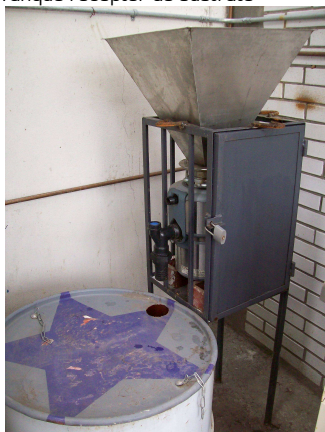
Triturador y tanque receptor de sustrato
