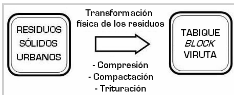
Figura I.10 - Esquema simplificado del tratamiento mecánico de los residuos sólidos urbanos (Elaboración a partir de INE-SEMARNAT, 2001b)
