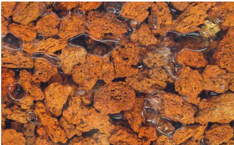
**Figura 4.5.** Flujo de burbujas a través del filtro
