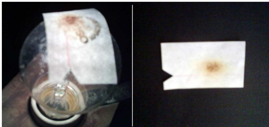
Figura 5.1 Daño causado por el calor del foco incandescente
