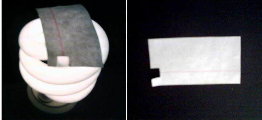
Figura 5.2 Efecto de la temperatura causado por el foco ahorrador
