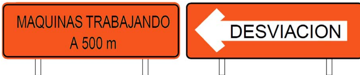
Figura 5.2 Señales informativas para protección en obra (SPI).
