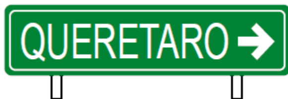
Figura 3.9 Señal de acceso a poblado (SID-8).
