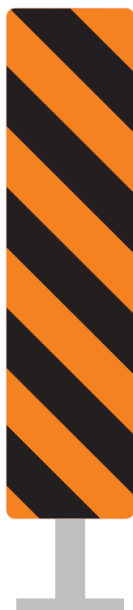
Figura 5.3 Indicador de obstáculos para protección en obra (DPC-6).
