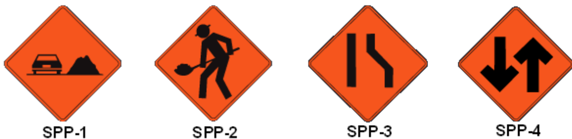
Figura 5.1 Señales preventivas para protección en obra (SPP).
