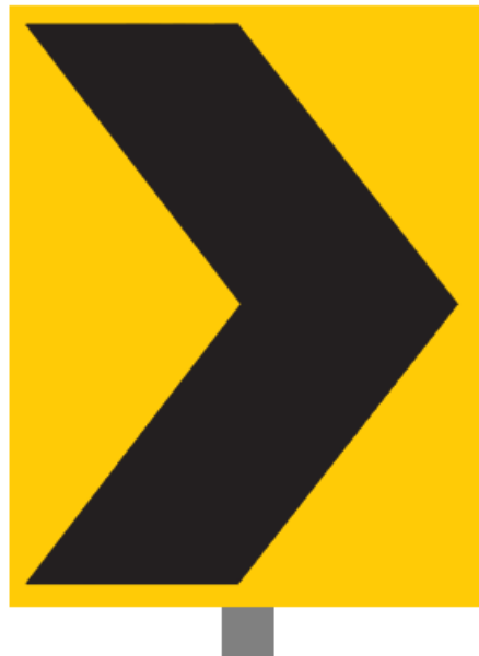
Figura 3.24 Señal de curva peligrosa (OD-12).
