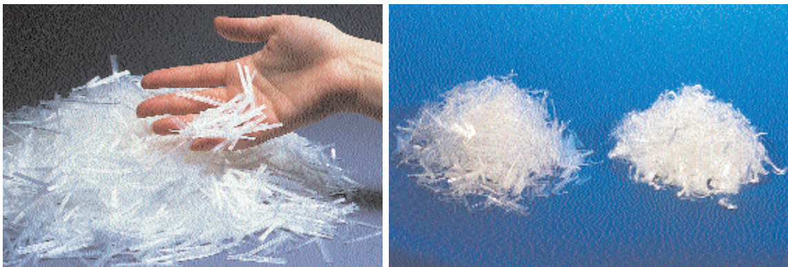
Figura 3.3 y 3.4 Fibras de polipropileno. Se producen como fibrillas finas con sección transversal rectangular (izquierda) o como monofilamentos cilíndricos (derecha).
