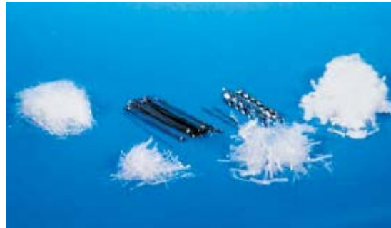
Figura 3.1 – Se pueden usar fibras de acero, de vidrio, sintéticas y naturales, con diferentes longitudes y formas para reforzar concreto. (PCA 2004)
