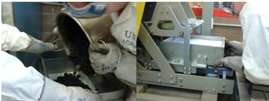
*Fig. 19 Se muestra el llenado de un molde con la mezcla asfáltica, y éste colocándose en el equipo de compactación*
