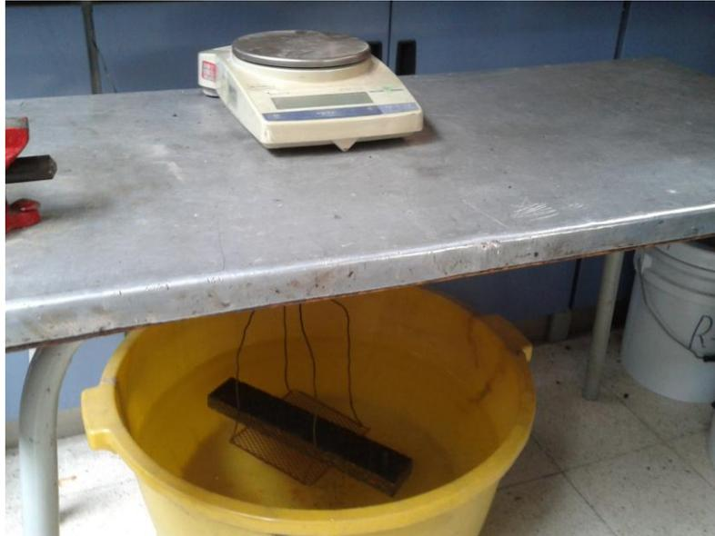
*Fig. 23 Cálculo de densidad en viga*
