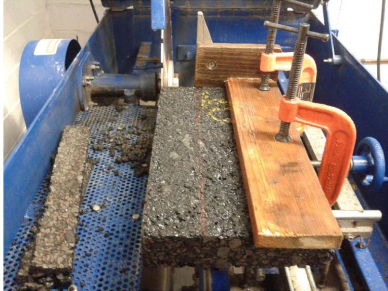
*Fig. 21 Obtención de vigas a partir del corte de la placa de mezcla asfáltica*
