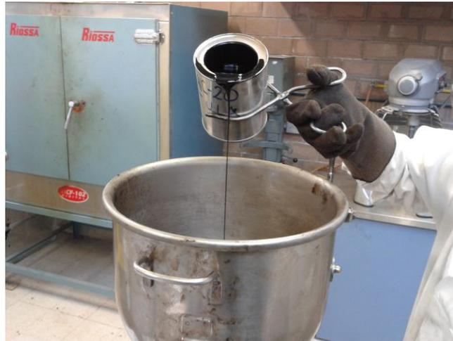
*Fig. 15 Dosificación de asfalto*
