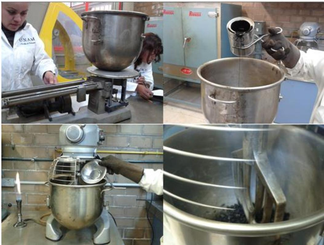
*Fig. 18 Se muestra parte del proceso de elaboración de las placas de mezcla asfáltica, incluye el pesado de los agregados pétreos y del asfalto, así como el mezclado de estos mismos.*
