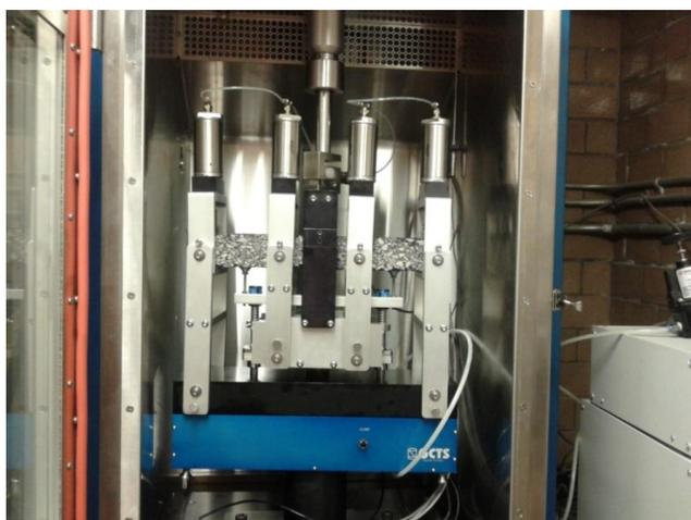
*Fig. 7 Equipo para prueba de fatiga en cuatro puntos.*
