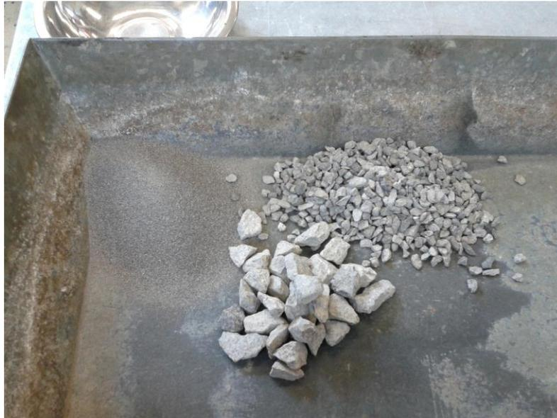
*Fig. 14 Dosificación de agregados para fabricación de mezcla asfáltica*
