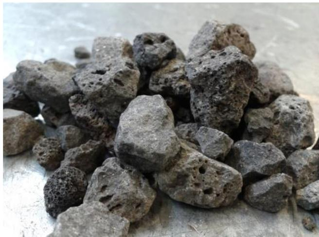
*Fig. 12 Basalto utilizado para las mezclas asfálticas con las que se realizaron los especímenes.*
