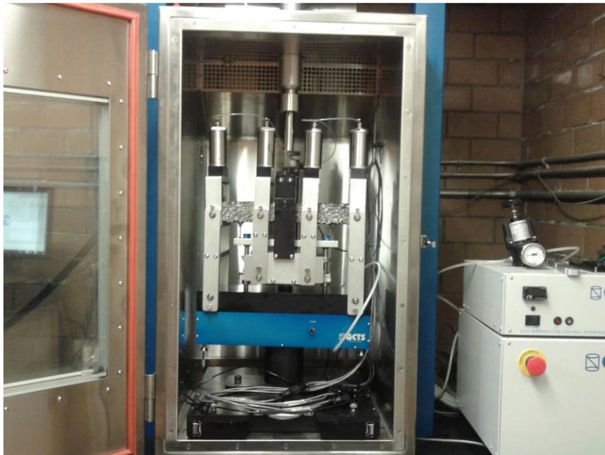
*Fig. 25 Colocación del dispositivo dentro de la cámara ambiental*
