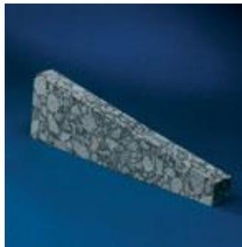
*Fig. 5 Probeta trapezoidal utilizada en el ensayo de fatiga a flexión en dos puntos. [14]*
