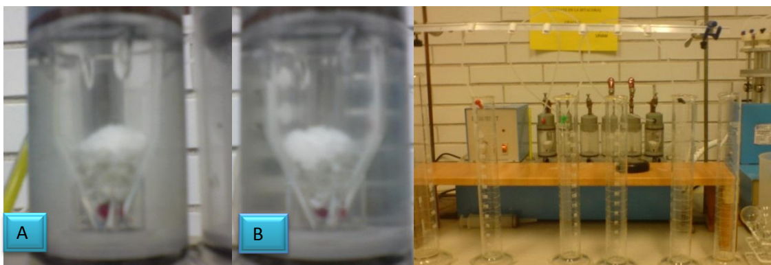
Figura 16. Pruebas de disolución realizadas en tabletas de ASA de un producto de referencia (A) y producto de prueba (B) para determinar las condiciones óptimas.
