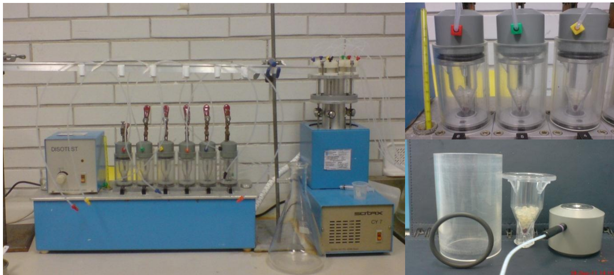
Figura 8. Aparato 4 USP (celdas de flujo continuo) utilizado para caracterizar perfiles de disolución de tabletas de ASA (producto genérico y producto de referencia).
