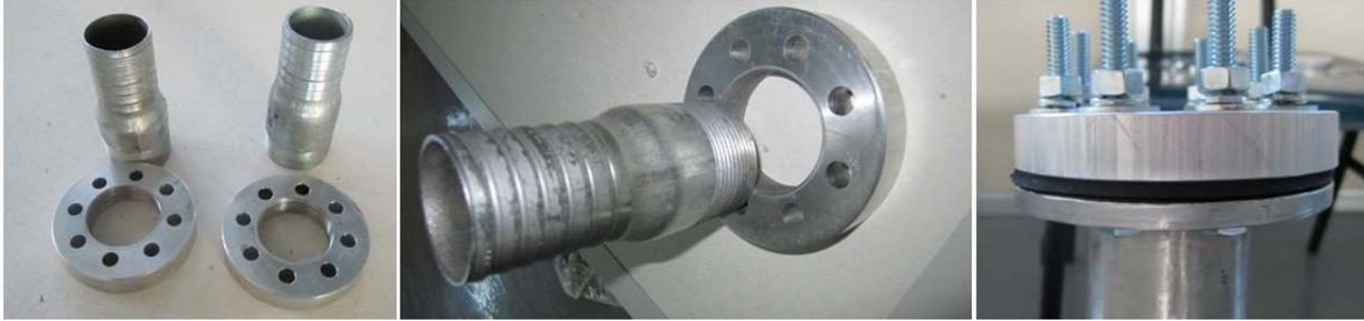
Figura 4.9 Bridas manufacturadas para D= 1 1/2' roscado interno NTP 11 1/2 la conexión de equipos. Aluminio
