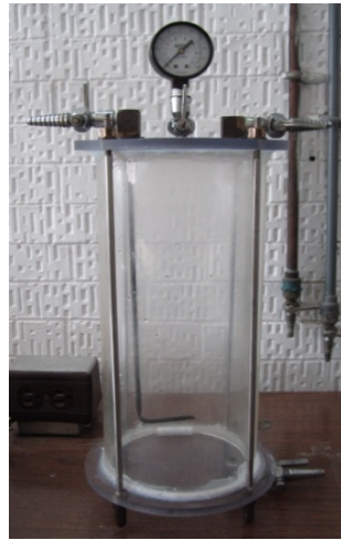
a) Reactor de policarbonato
