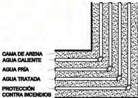
PLANTA DE TRINCHERA INST. HIDRAÚLICA
