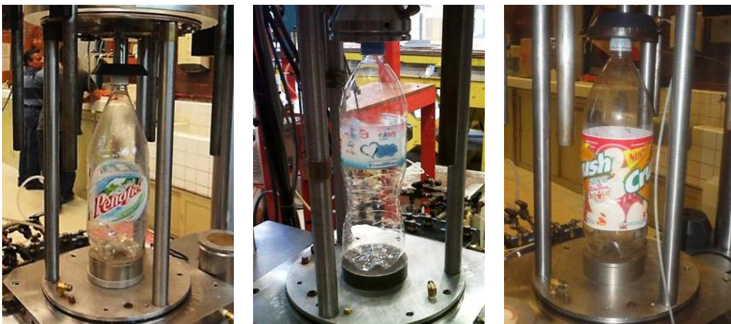
Ensayos en la MTS a envases vacíos
