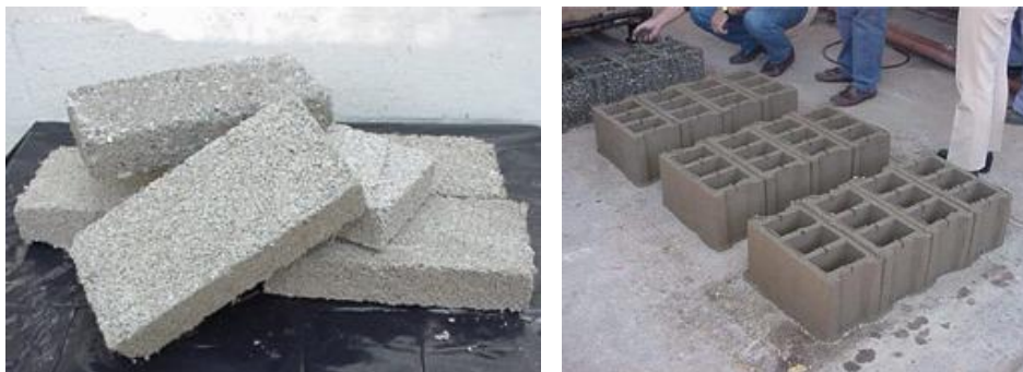
Ladrillo hechos con la trituración del PET
