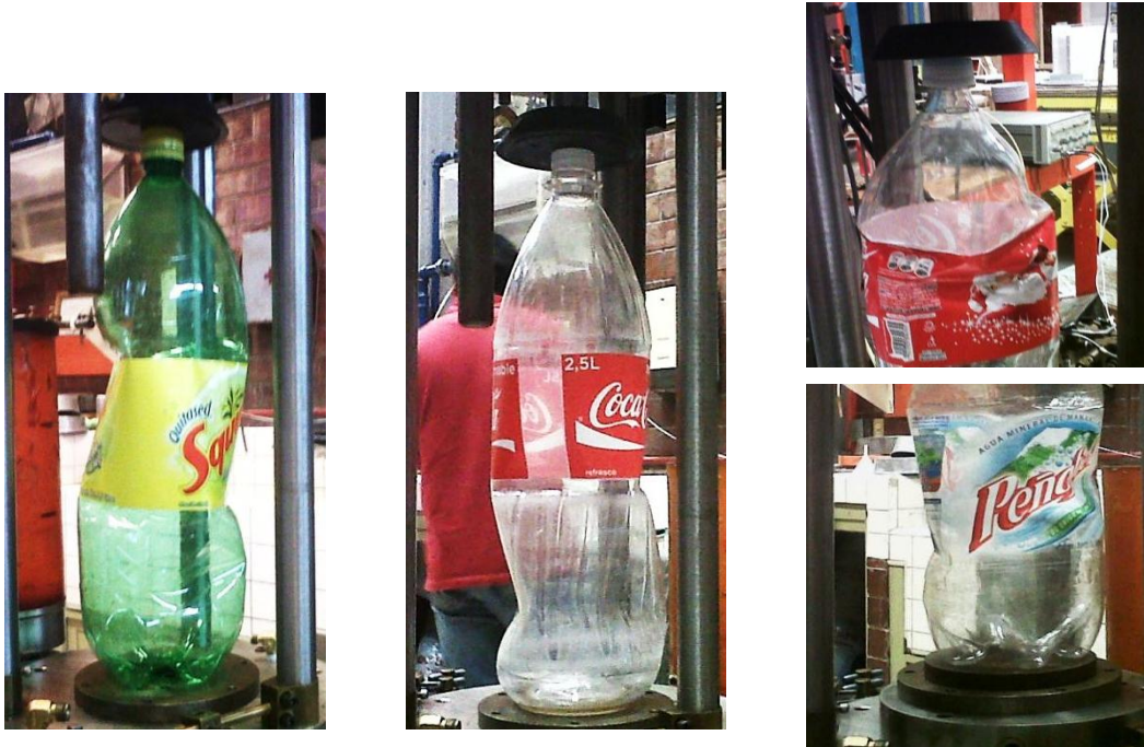
Figura 4.3 Deformaciones excesivas en algunos tipos de botellas causante de grandes pérdidas de resistencia
