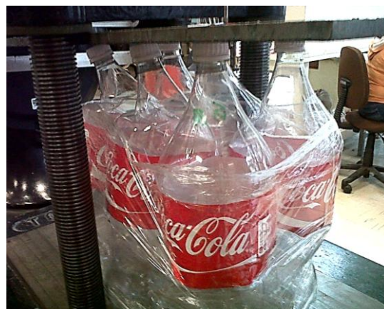
Figura 4.8 Falla provocada por la falta de verticalidad ocasionada en ciertos envases al momento de colocar la placa metálica
