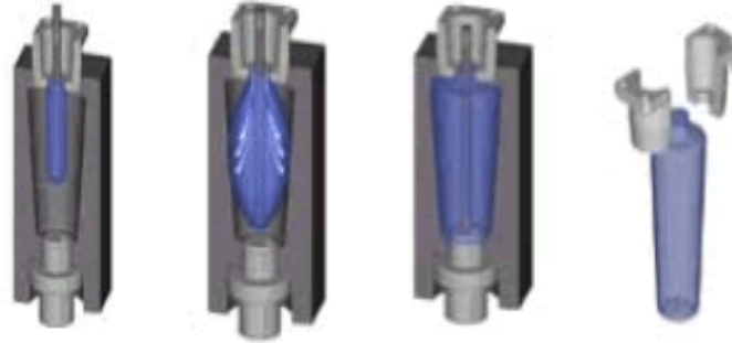
Producción de envase mediante proceso de inyección sople biorientado
