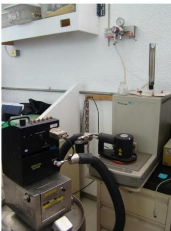
**Fig. 3.4** Dispositivo TA para la medición de DSC, Instituto de Ciencias Nucleares
