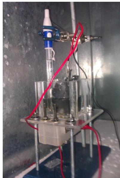
**Fig. 3.3** Dispositivo (celda de acrílico) para la realización de las mediciones en EIS
