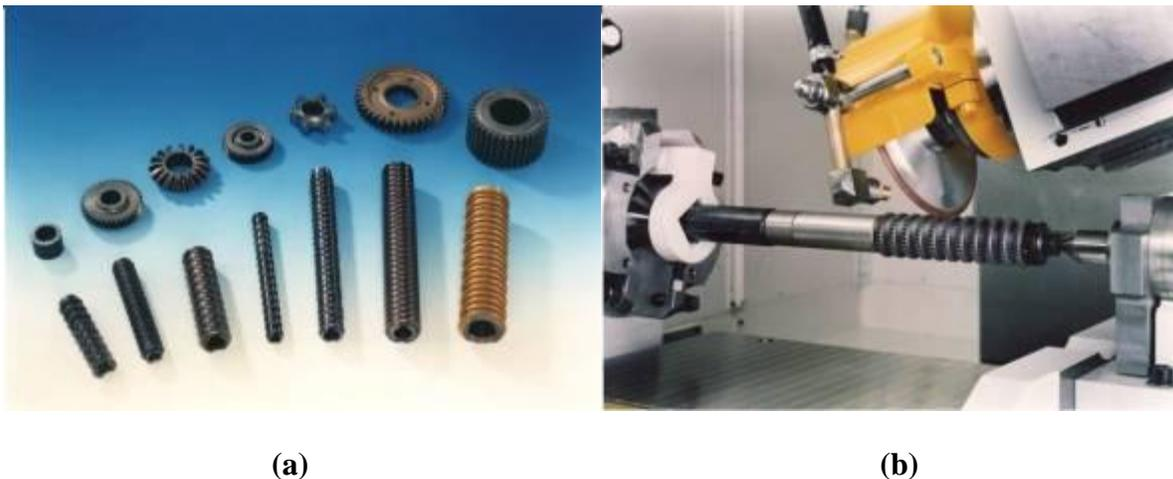
**Figura 1.5. (a) Engranés manufacturados mediante el proceso de brochado y sus respectivas brochas. (b) Procesos de brochado de engranes. Imágenes de *GUiMA Máquinas- Herramienta S. L.*, tomadas del sitio: [http://www.guima-mh.com/maqui\\_2/maqui\\_2.htm](http://www.guima-mh.com/maqui_2/maqui_2.htm), (Fecha de actualización: 17 de octubre de 2012).**
