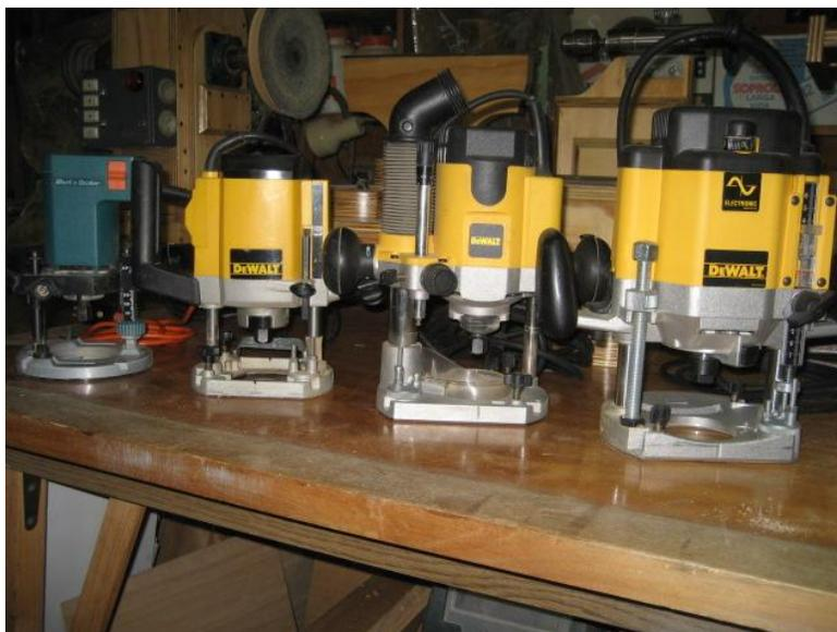
**Figura 3.1. Diferentes tipos de routers manuales. Imagen de *Hecho por Nosotros Mismos 2010*, tomada del sitio: <http://img816.imageshack.us/img816/9380/img4783.jpg>, (Fecha de actualización: 17 de octubre de 2012).**
