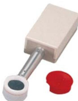
Figura 30. Cámara de ionización RADCAL 20X6-6M
