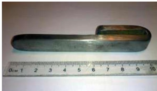
**Figura 3.3** Fotografía del sujetador de acero para realizar los experimentos destinados a determinar el efecto de la temperatura en el comportamiento de la cinta de celofán.
