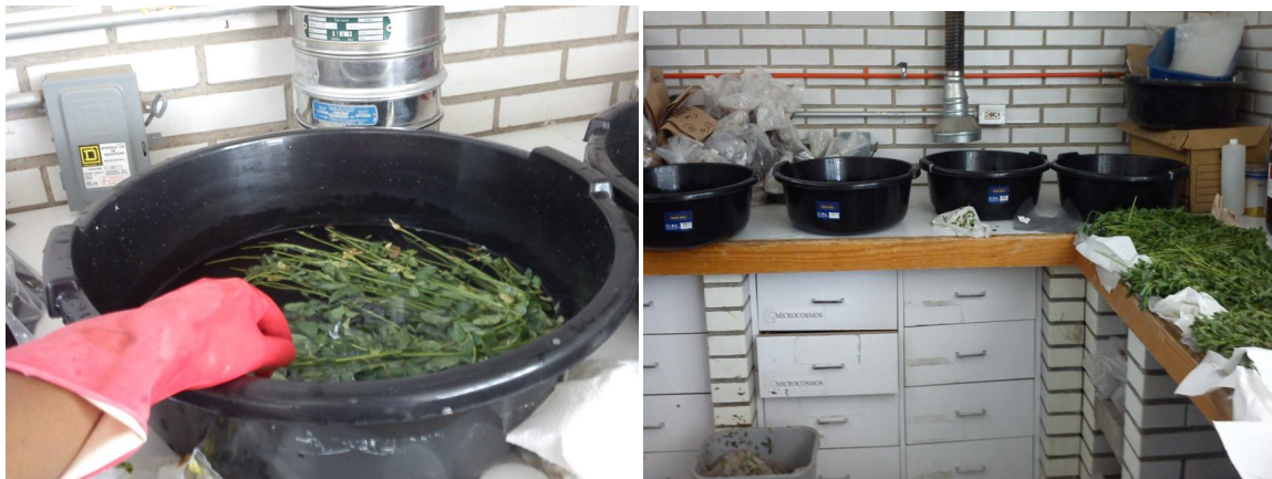
Figura 6. Lavado de las muestras de alfalfa en \text{HNO}_3 0.1 M
