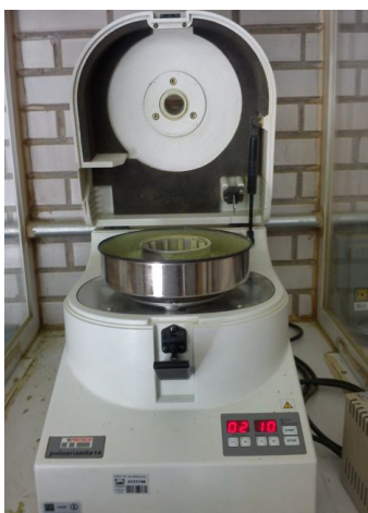
Figura 7. Molino utilizado para la molienda de las muestras de alfalfa.
